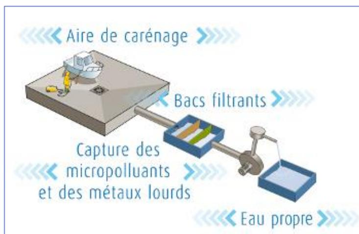
Schéma simplifié d'une aire de carénage mise aux normes (source AELB)
