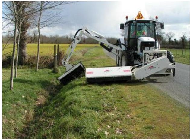
Figure 6. Fauchage d'un fossé à l'aide d'une épareuse
