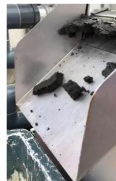
Déshydratation par pression et sédiments fins déshydratés obtenus
